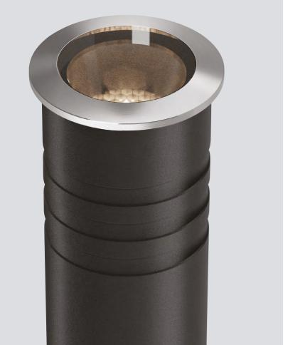
Грунтовые светильники POINT IN с индексом пылевлагозащиты ІР67 состоят из двух частей – стакана для предварительного монтажа в грунт и самого светильника со стальной декоративной рамкой. Рассеиватель выполнен из каленого прозрачного стекла, что обеспечивает дополнительную прочность и термостойкость. Повышенный показатель ударопрочности — IK07.
