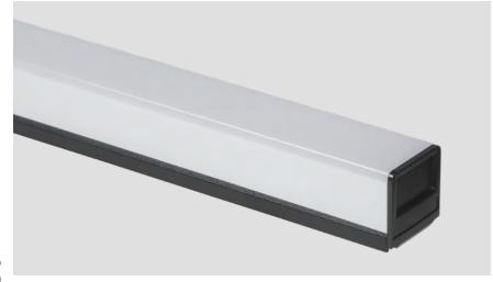
Линейный светильник Лайн — это главный инструмент низковольтной трековой системы для общего освещения. Корпус выполнен из экструдированного алюминия и осуществляет необходимый светодиодам теплоотвод. П-образный рассеиватель состоит из двух материалов: белый — для увеличения светоотдачи, полупрозрачный — светопропускающий, дающий равномерное свечение без видимых точек.
