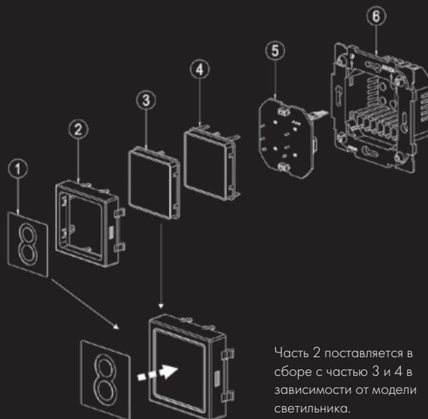
Часть 2 поставляется в сборе с частью 3 и 4 в зависимости от модели светильника.
