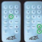
Сканирование диапазона частот (SCAN)
