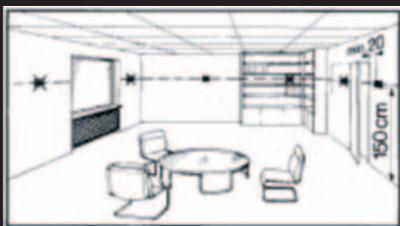
Термостат должен быть размещен в комнате, где необходимо контролировать температуру, за исключением тех случаев, когда необходимо контролировать только температуру теплого пола.
